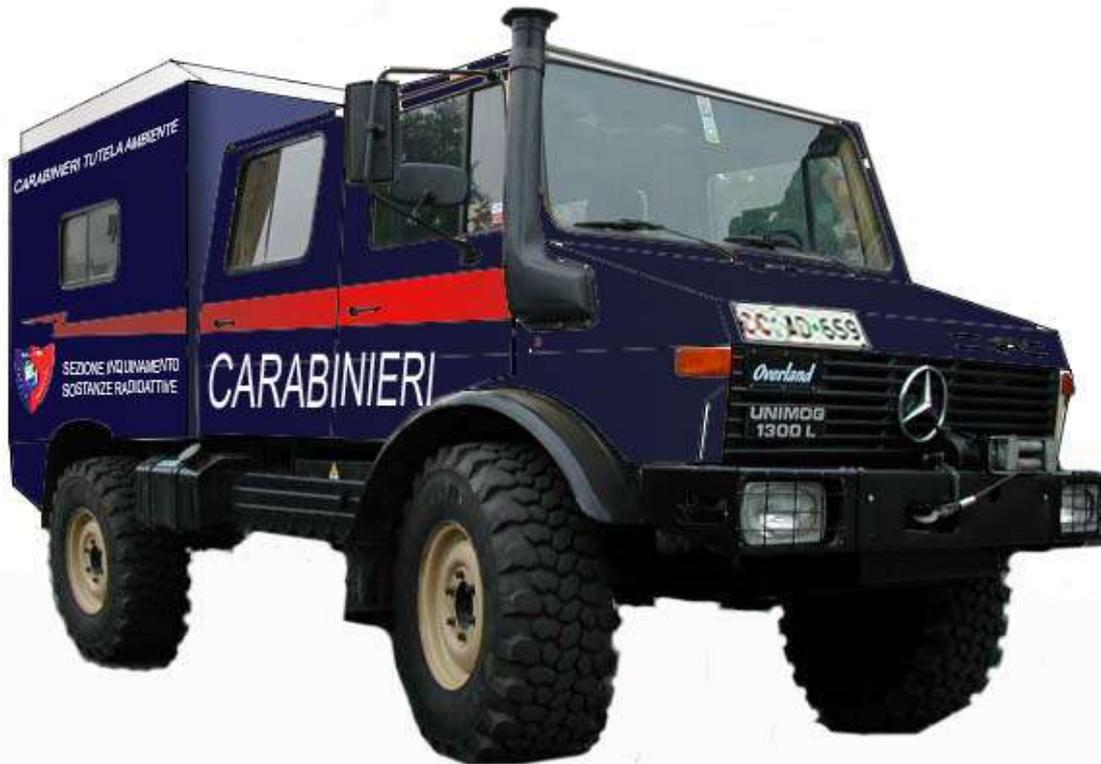
Il laboratorio mobile UNIMOG consente di effettuare analisi terraria di tipo “R” e di trasmettere, in tempo reale, via satellite i dati raccolti.
