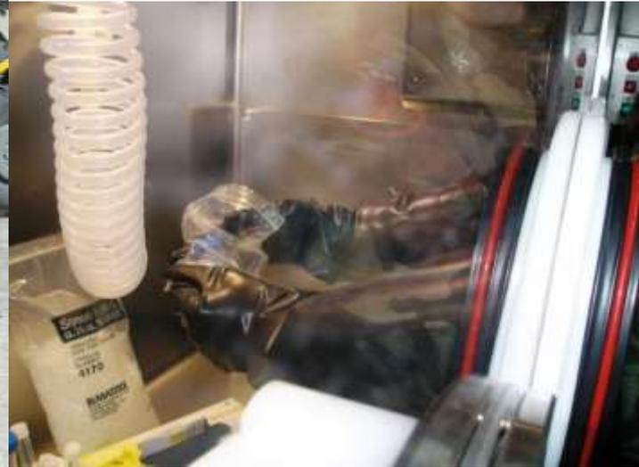
Il **BioLab** è un laboratorio di analisi che consente l'analisi di campioni di sospetta contaminazione biologica nelle matrici solida, liquida ed aeriforme. Il livello di biosicurezza è 3 (BSL-3: contenimento ed analisi agenti come SARS, peste, encefalite equina, ecc.). È montato su shelter ed è in grado di operare in zona contaminata.
