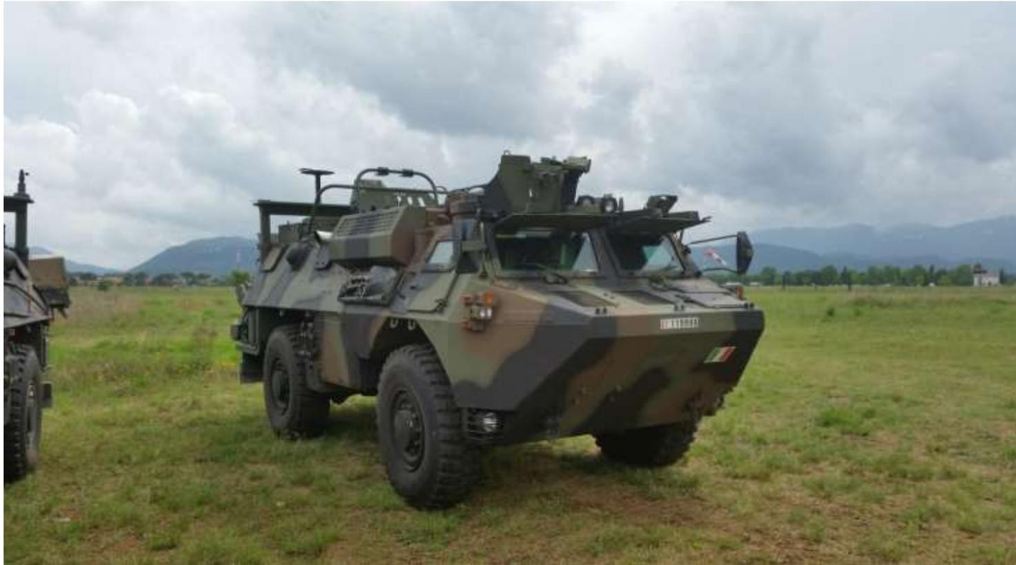
Il **VBR NBC Plus** è un veicolo leggero blindato su ruote idoneo a condurre missioni di ricognizione di tipo chimico e radiologico e campionamento Bio. Dotato di differenti sistemi di rilevamento e campionamento, permette di realizzare la mappatura radiologica e chimica dell'Area di Osservazione, la delimitazione delle aree contaminate e la trasmissione dei dati integrati con le condizioni meteo locali
